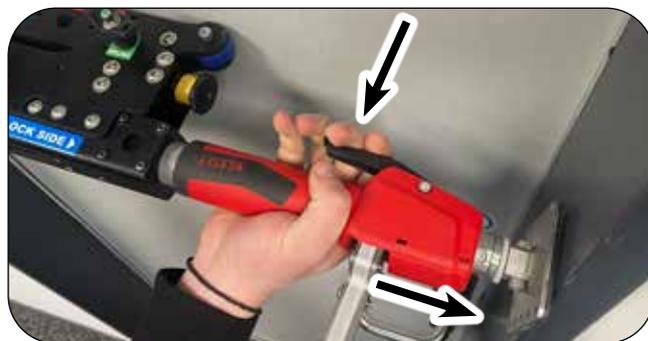
Die Klemmverriegelung im Uhrzeigersinn drehen bis das INSIGHT stramm und fest am Türrahmen verankert ist.
